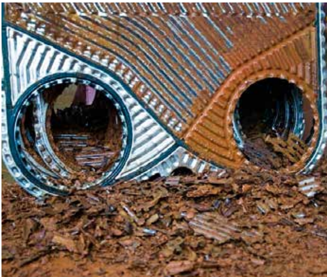
Пластинчатый теплообменник, забитый отложениями шлама
